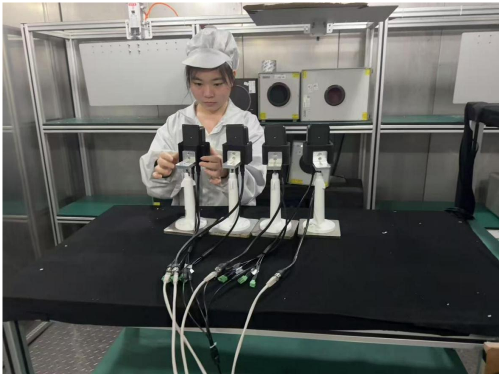
图 1-10 学生党员张志萍正在认真地对新产品进行低温测试
